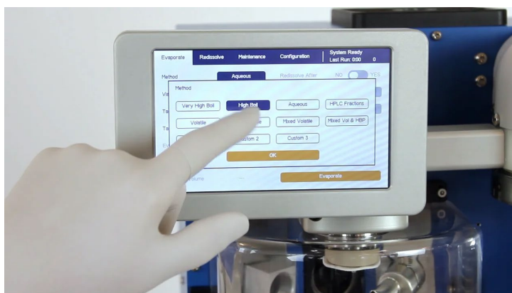
Ekran dotykowy umożliwiający sterowanie i kontrolę procesu odparowania.
