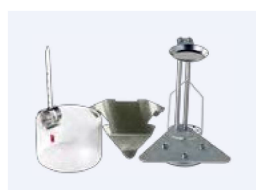
Zestaw do pomiaru ciężaru właściwego SMK-601
